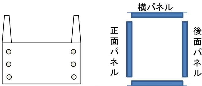
印にあわせて、「パネル用組立ビス41mm」を4本ずつ打ち込みます。
